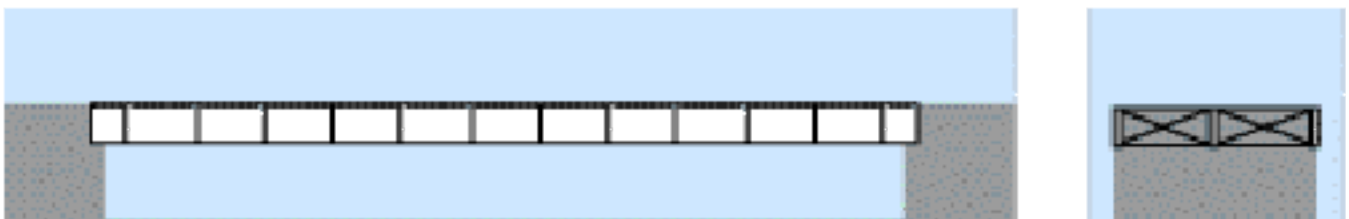
Γέφυρα διάταξης deck υποστηριζόμενη (το κατάστρωμα είναι πάνω σε πλάκες οι οποίες εδράζονται σε τραβέρσα)
