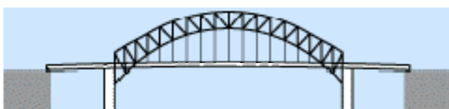
Δικτυωτή Τοξωτή Γέφυρα διάταξης through
