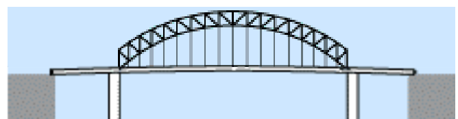
Αμφίπακτη Δικτυωτή Τοξωτή Γέφυρα διάταξης through
