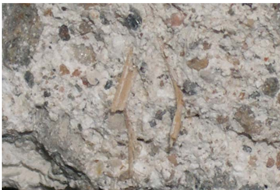
Εικόνα 3/9 Διακρίνουμε το πόσο χονδρόκοκκο είναι το ασβεστοκονίαμα, καθώς επίσης και τα ξηρά χόρτα που είναι αναμεμιγμένα.
