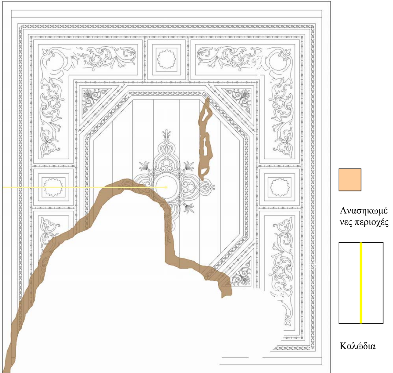
Σχέδιο II/ 46 Αποτύπωση σχεδίου και φθορών (φουσκώματα, καλώδια).
