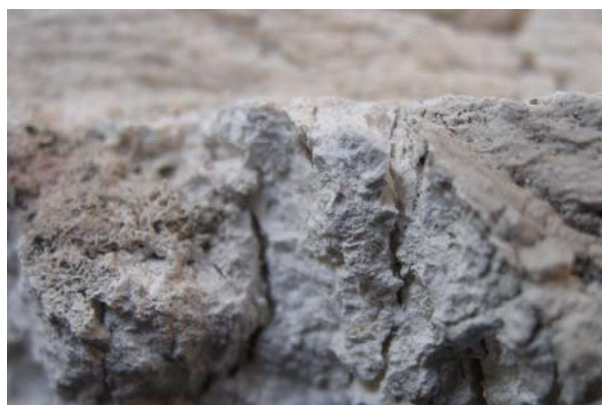
Εικόνα Ι/129 Λεπτομέρεια του δείγματος 3, διακρίνουμε το αρκετά λευκό χρώμα του κονιάματος τ οποίο μās οδηγεί στο συμπέρασμα ότι πρόκειται για ασβεστοκονίαμα με μαρμαρόσκονη
