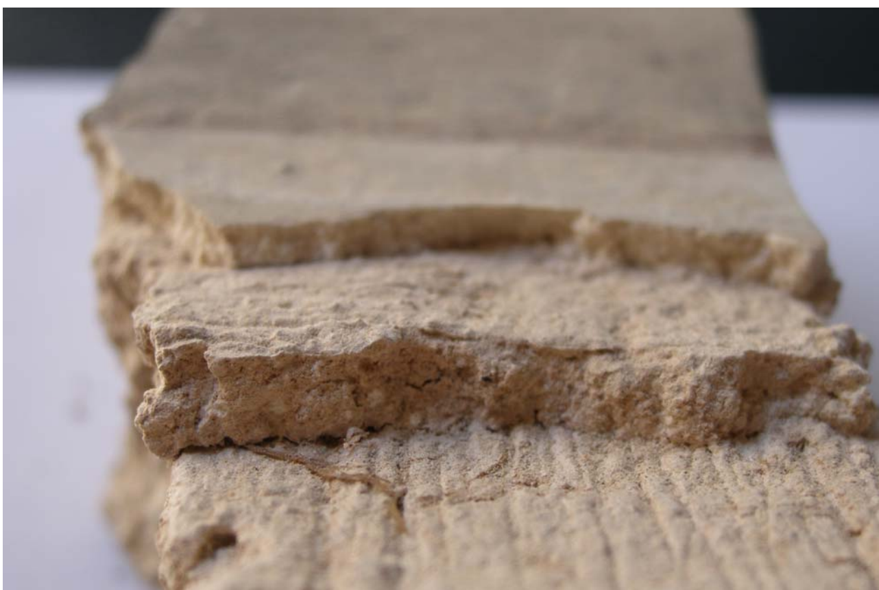
Εικόνα Ι/124 Λεπτομέρεια του δείγματος 2 της εικόνας 123, Διακρίνουμε καθαρά τα επάλληλα στρώματα του κονιάματος.
