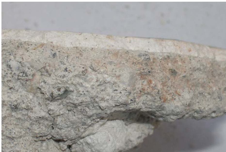
Εικόνα Ι/135 Δείγμα 5 κομμάτι από τοιχογραφία του δωματίου 5 στον όροφο. Διακρίνουμε τα δύο επάλληλα στρώματα κονιάματος. Το στρώμα που αποτελεί την προετοιμασία της ζωγραφικής είναι κατά πολύ λευκότερο.
