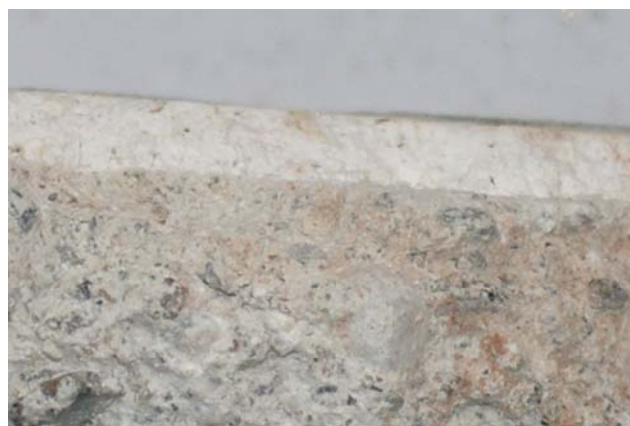
Εικόνα 3/14 Στρωματογραφία επάλληλων στρώσεων κονιάματος σε κομμάτι από τοιχογραφία. Διακρίνουμε τα δύο επάλληλα στρώματα και την έντονη διαφορά στην κοκκομετρία μεταξύ τους.
