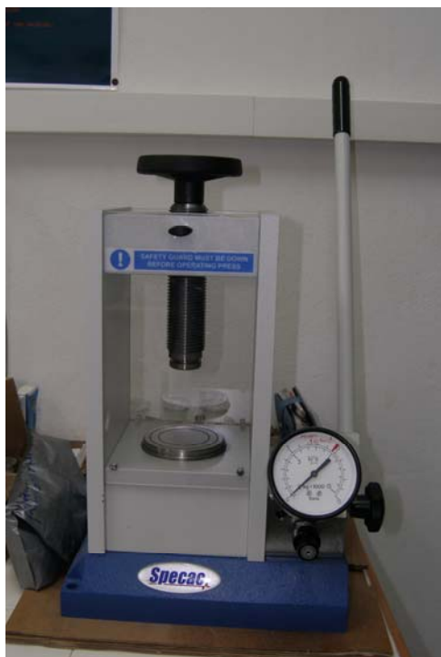
Εικόνα 5/3 Πρέσα τύπου Specac για την κατασκευή παστίλιας δειγμάτων από KBr
