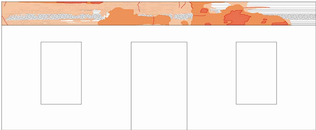
Σχέδιο II/ 87 Αποτύπωση σχεδίου και φθορών διακοσμητικής ταινίας .του τοίχου ΔΑ
