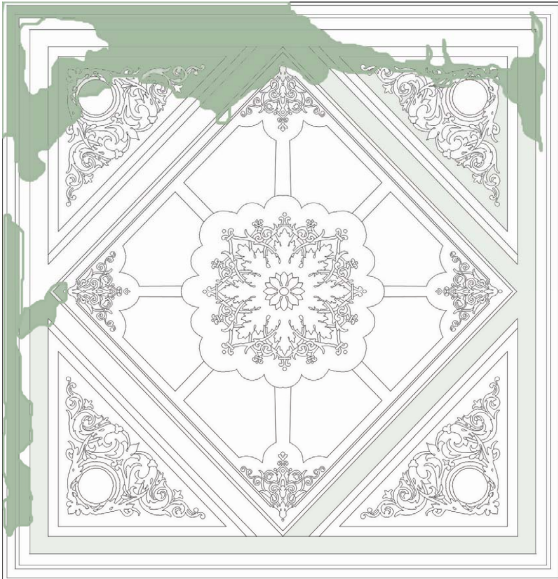
Σχέδιο II/ 62 Αποτύπωση σχεδίου και βιολογικών παραγόντων.
