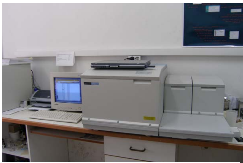
Εικόνα 5/1 Το φασματοφωτόμετρο FTIR του εργαστήριου ΦΜΤ του Τμήματος ΣΑΕΤ
