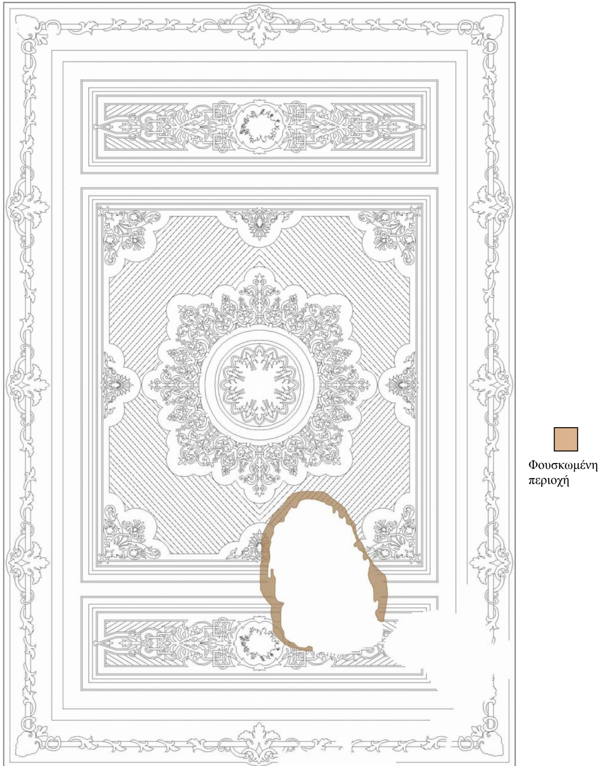
Σχέδιο Π/ 11 Αποτύπωση σχεδίου και φθορών της οροφografίας
