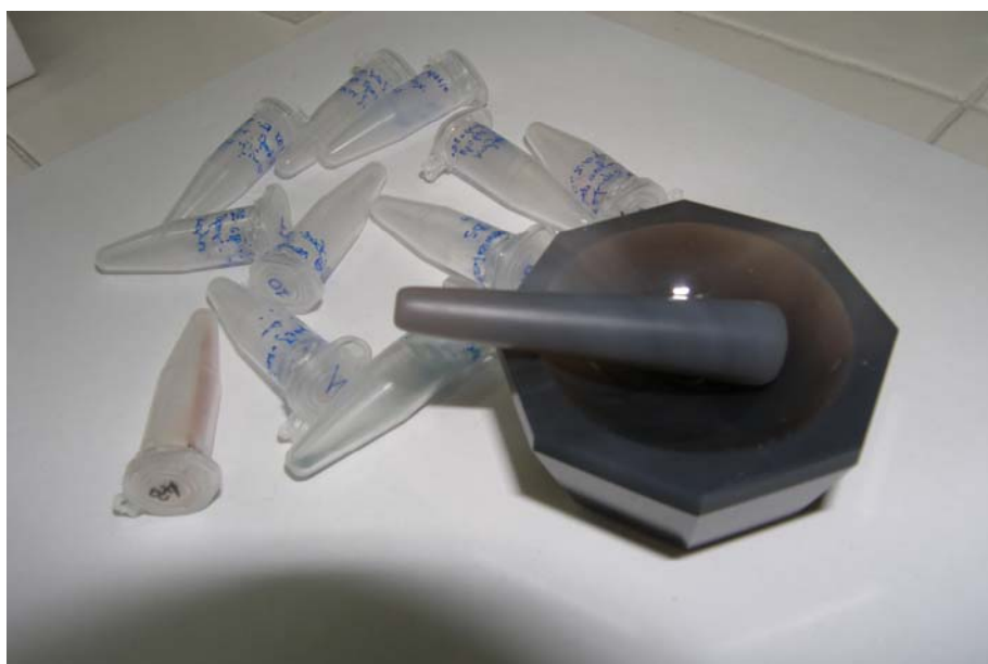
Εικόνα 5/2 Δοχεία αποθήκευσης ( Eppendorf ) των δειγμάτων και σκεύος θλίψης και ανάμιξης με KBr
