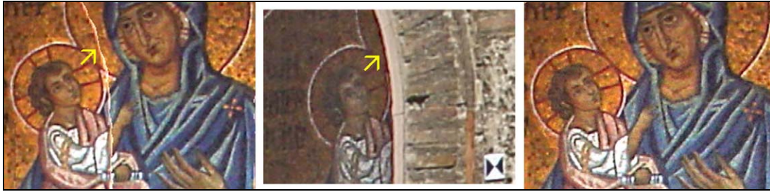
Εικόνα 20. Αριστερά: ορθοπροβολή από 7 εικόνες. Μέσον: αρχική εικόνα, στην οποία οφείλεται η λόγω εγγύτητας σε όριο απόκρυψης εμφάνιση λευκού σχηματισμού στην ορθοφωτογραφία. Δεξιά: αυτόματη ραδιομετρική διόρθωση της ορθοφωτογραφίας με αποκλεισμό των εσφαλμένων τιμών χρώματος από την αποκρύπτουσα επιφάνεια.
