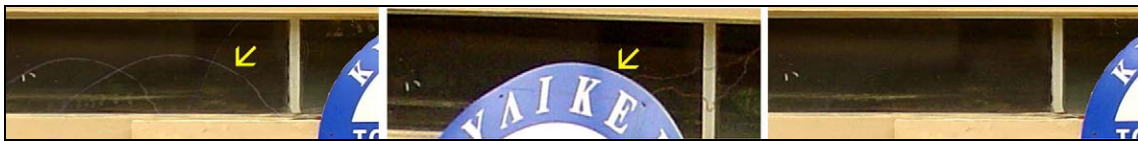
Εικόνα 21. Παράδειγμα αντίστοιχο με εκείνο της Εικ. 20. Η αρχική εικόνα στο μέσον είναι υπεύθυνη για έναν από τους δύο λευκούς σχηματισμούς (αριστερά), οι οποίοι εξαλείφονται αυτόματα μέσω του ελέγχου της διασποράς των τιμών χρώματος (δεξιά).
