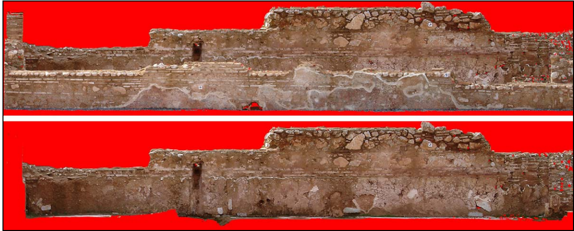
Εικόνα 50. Τελική ορθοφωτογραφία και τομή (κάτω) του τμήματος 2 του μοντέλου.
