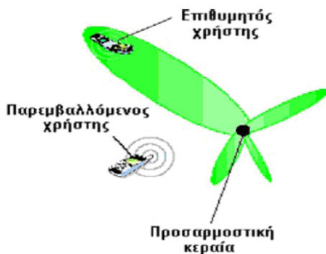
Σχήμα 32. Λειτουργία κεραίας adaptive array όταν υπάρχει και παρεμβάλλον χρήστης
