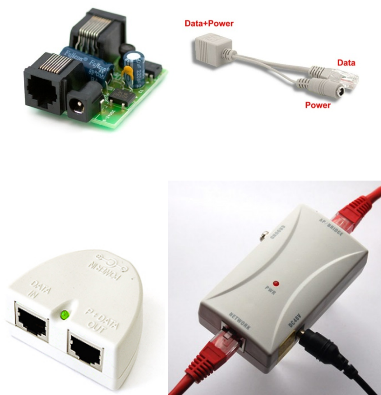
Σχήμα 41. Συσκευές που χρησιμοποιούν την τεχνολογία POE (POE Injectors)
