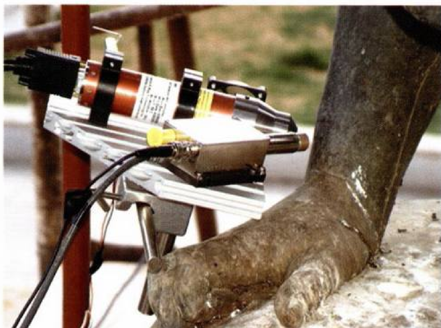
Φωτογραφίες από το άγαλμα και το φορητό σύστημα φασματοσκοπίας XRF που χρησιμοποιήθηκε στις μετρήσεις
