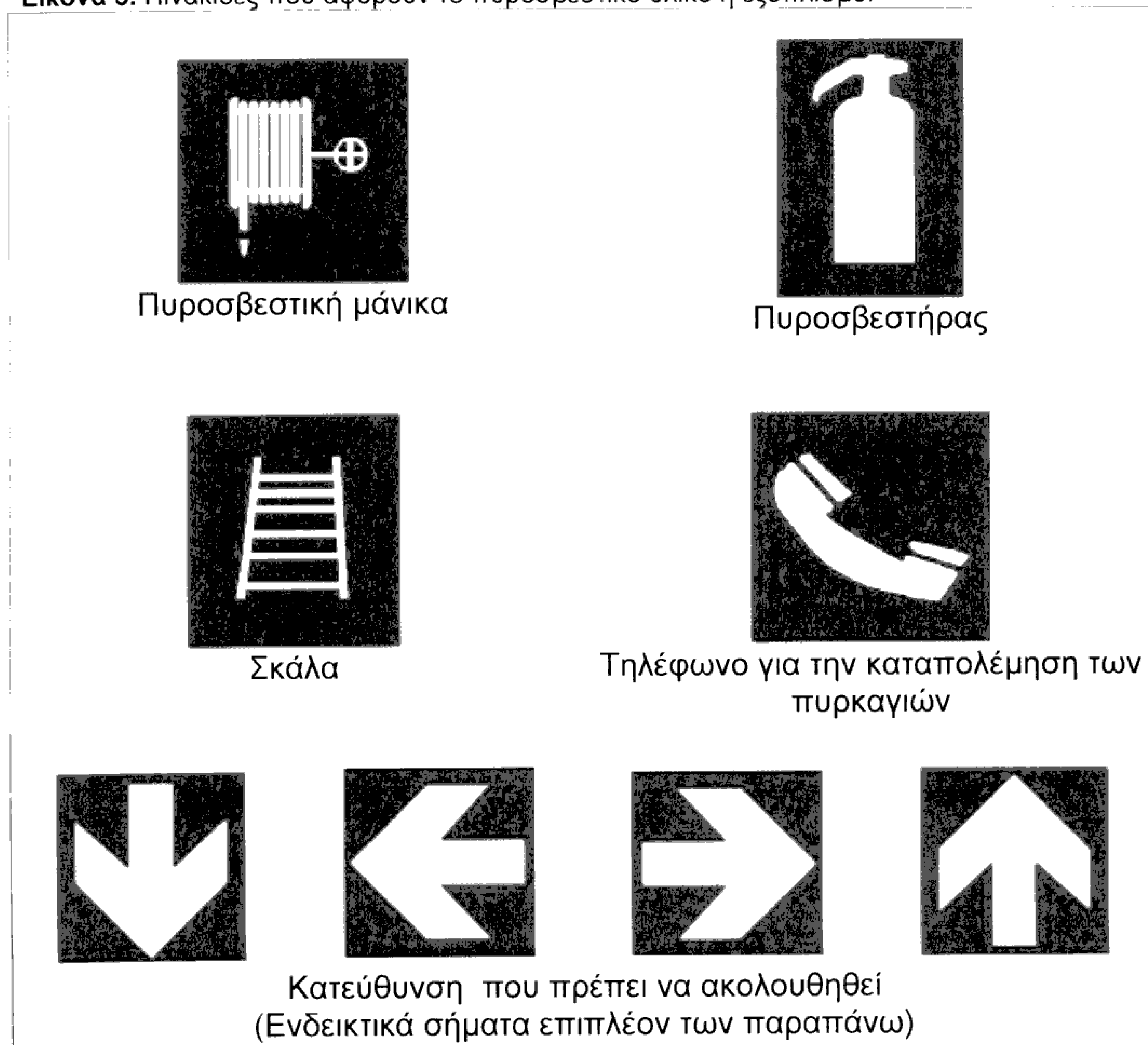
Εικόνα 5. Πινακίδες που αφορούν το πυροσβεστικό υλικό ή εξοπλισμό.
