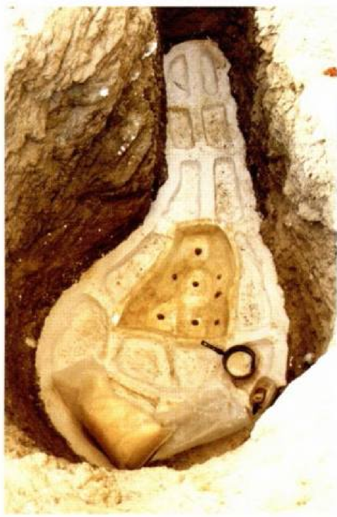
© Διαδικασία κατασκευής εκμαγείου του χυτηρίου με γύψο και λάστιχο σιλικόνης.
