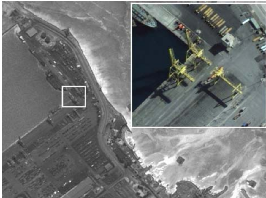
Εικόνα 36: Σύγκριση ανάμεσα σε μία παγχρωματική εικόνα του SPOT-5 χωρικής ανάλυσης 2.5 m και σε μία εικόνα pan-sharpened του Quick-Bird χωρικής ανάλυσης 61 cm.
