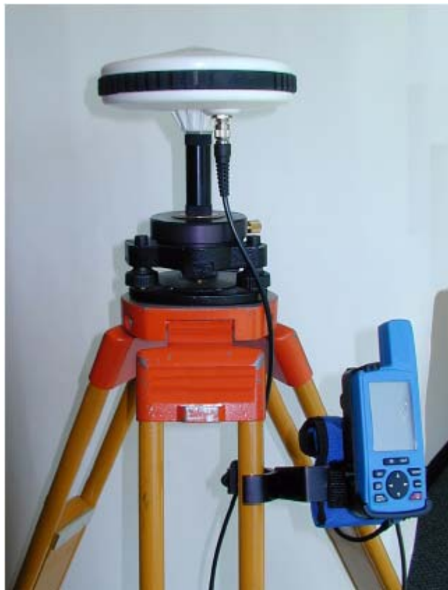
GPS PROMARK 2 δέκτης σε τρίποδο για τριγωνισμούς, ίδρυση φωτοσταθερών, πολυγωνομετρία, αποτυπώσεις
