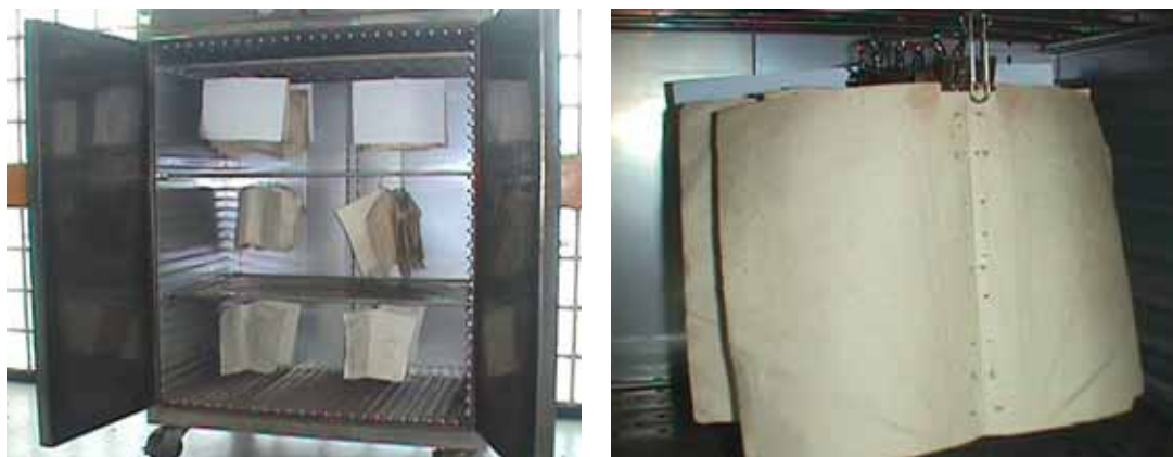
Εικόνα 24: Το πυριατήριο και ο τρόπος ανάρτησης των δειγμάτων
